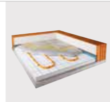
Podlahové vytápění/ chlazení TAC Mokrý systém
