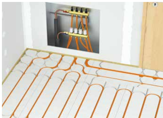
Pukový prvok Therm 25 pred rozdeľovačom vykurovacích okruhov s prefrezovanými drážkami
