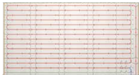
Pokládka vykurovacích rúrok (15 alebo 16 mm)
