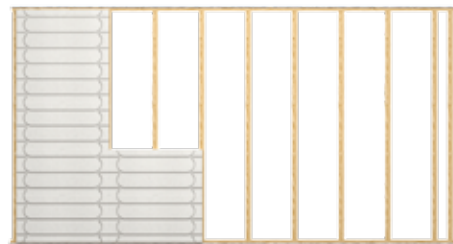
Montáž Therm25 do spodnej konštrukcie (skrutky 40 mm alebo sponky 50 mm)
