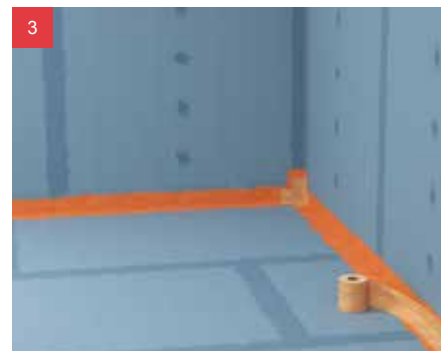
3 Zatlačte tesniacu pásku fermacell® do vlhkej tekutej fólie.
