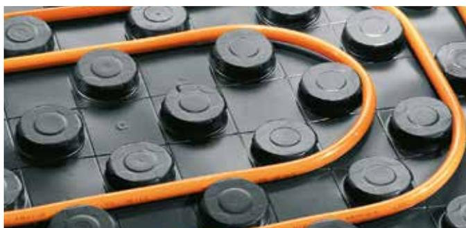
9. Minimálny polomer oblúka rúrok sa dosiahne ohybom okolo 3 výstupkov pri ohybe o 180°, príp. okolo 2 výstupkov pri ohybe o 90°. **Pozor:** Platí len u dosiek s rozostupom RA 75 mm. U dosiek RA 50 mm je nutné postupovať individuálne. **Nikdy nesmie dôjsť pri inštalácii k prelomiu rúrky. Ak k tomu dôjde je nutné rúrku v mieste poškodenia vystrihnúť!**
