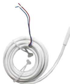
externí snímač typ NTC 10k Ω na 25 °C (β = 3950)
