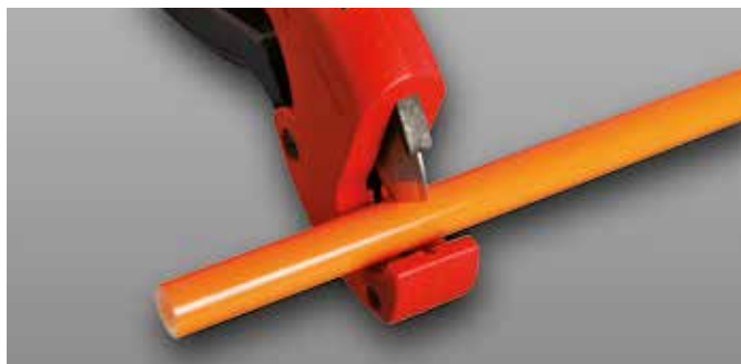
obr. 1: Označenou trubku zkrátte
